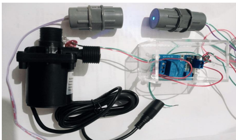
Gambar 4. Rangkaian otomasi pengendali pompa
