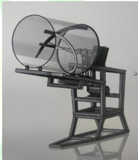
Gambar 3. Rancangan mesin pengaduk keripik singkong Sumber: hasil rancangan
